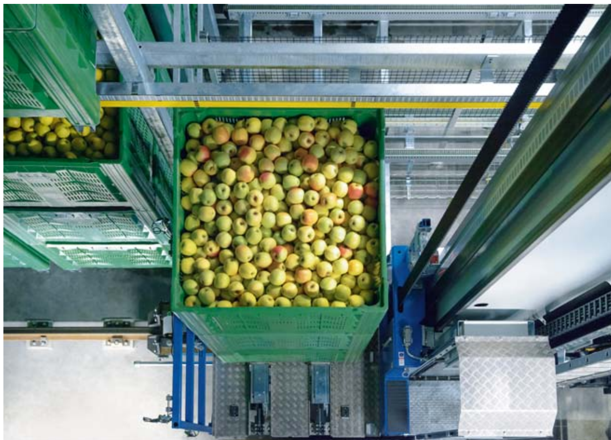
Acht ganggebundene RBG mit Riemenantrieb im Hub kommen bei Geos zum Einsatz.
