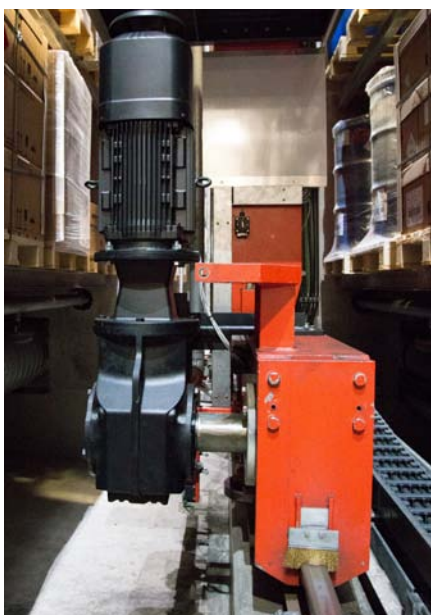
Explosionsschutzierter Fahrwerksgetriebemotor von SEW am Regalbediengerät. (Foto: Born)
