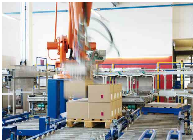
⑤ Ein Roboter übernimmt das Handling der aus der Produktion kommenden Kartons und stapelt sie auf die Paletten.
